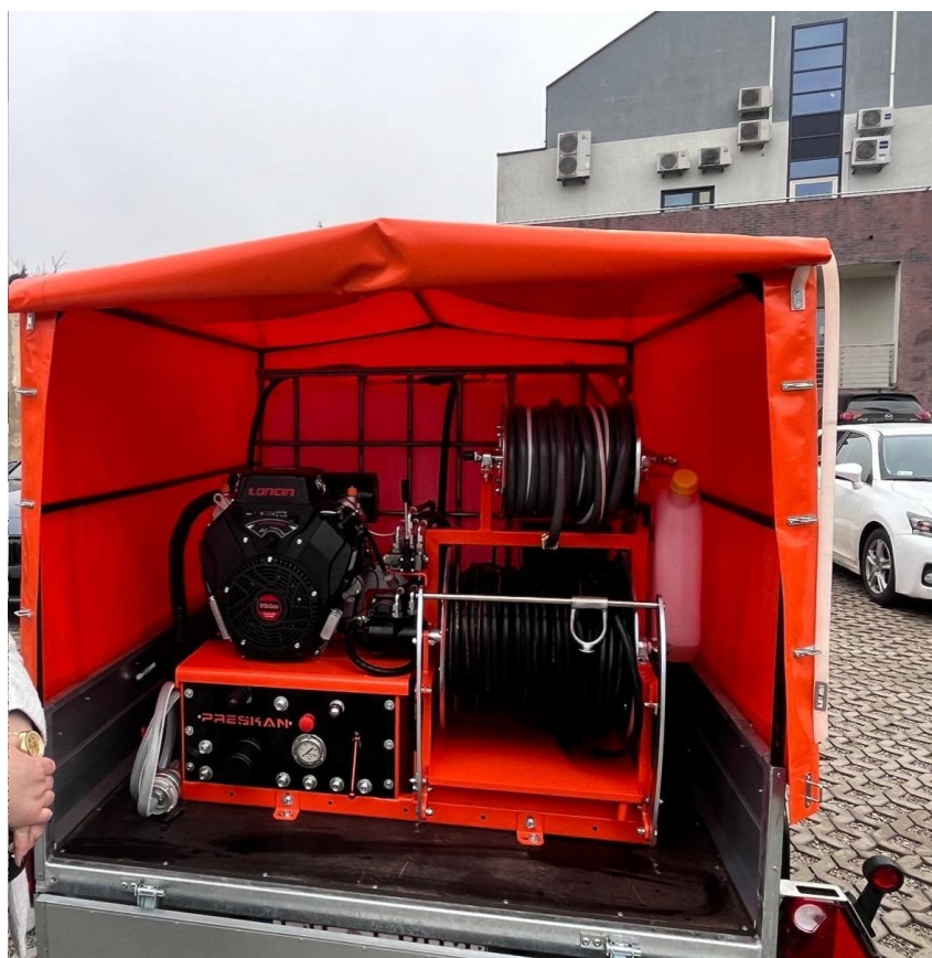
Maszyna ciśnieniowa do udrożnienia i czyszczenia rur kanalizacyjnych wraz z przyczepą transportową (WUKO) – fot. Urząd Gminy Pionki
